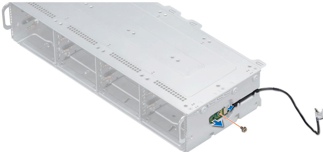
図 75. センサーボードの取り外し
