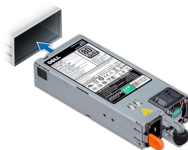
図 30. 電源装置ユニットの取り付け
