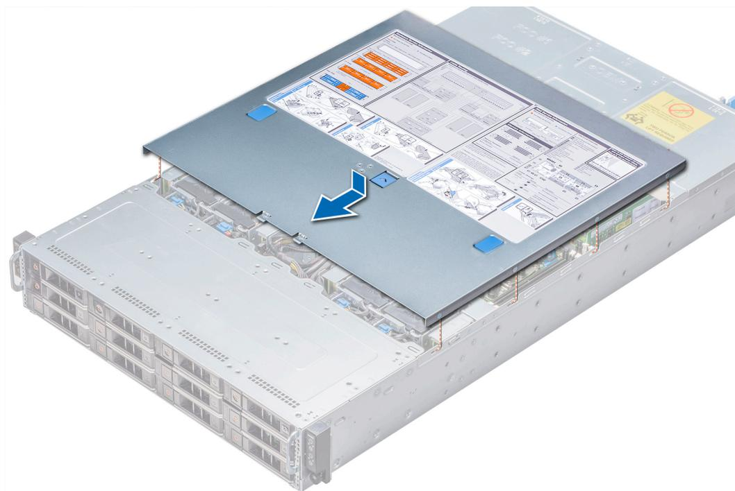
図 32. システムカバーの取り付け
