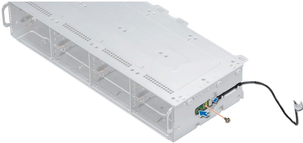
図 76. センサーボードアセンブリーの取り付け
