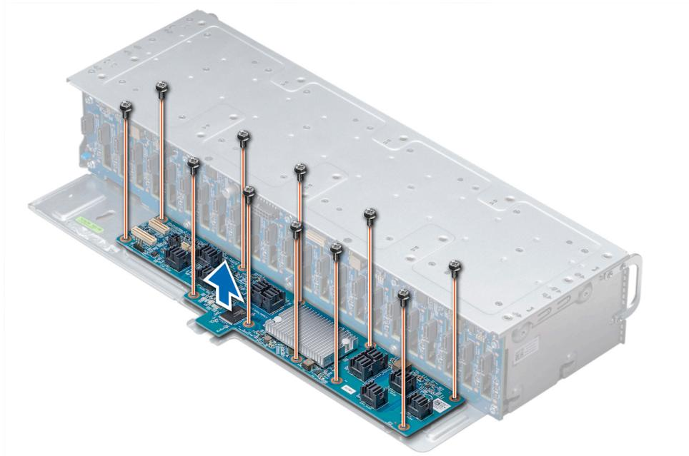
図 69. バックプレーン エクスパンダ ボードの取り外し
