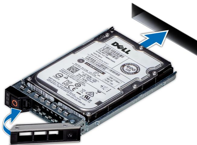
図 26. ドライブ キャリアの取り付け
